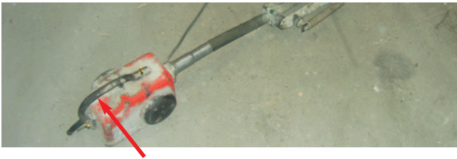
Stavvibrator med vibrationsdæpende håndtag
