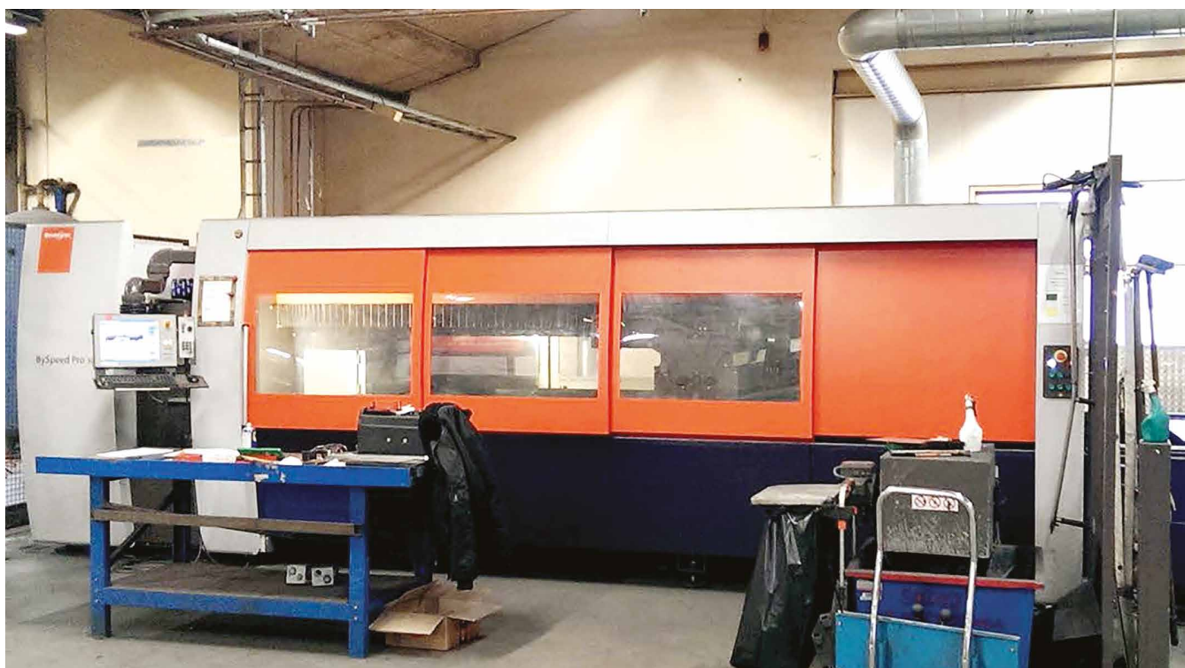
Eksempel på lukket procesudsugning fra maskine
